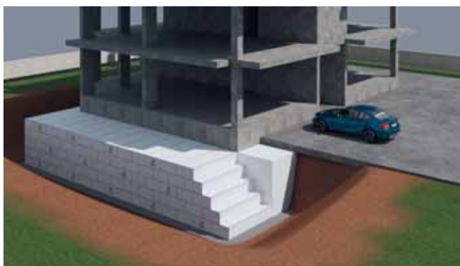
Снимка 4 Завършване на приложения, намаляване на страничните сеизмични натоварвания върху носещи конструкции и снимка.
