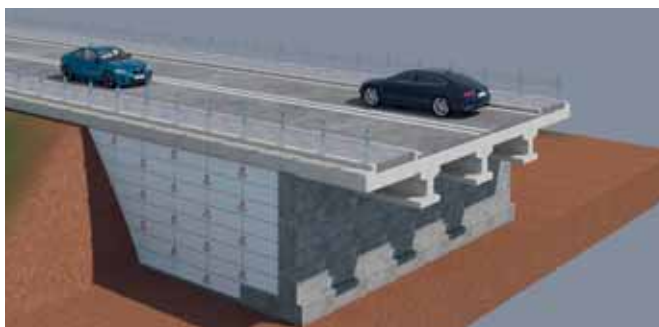
Снимка 2 Предотвратяване на слягане в конструкции за достъп до насипа на откоси и меки почви.
