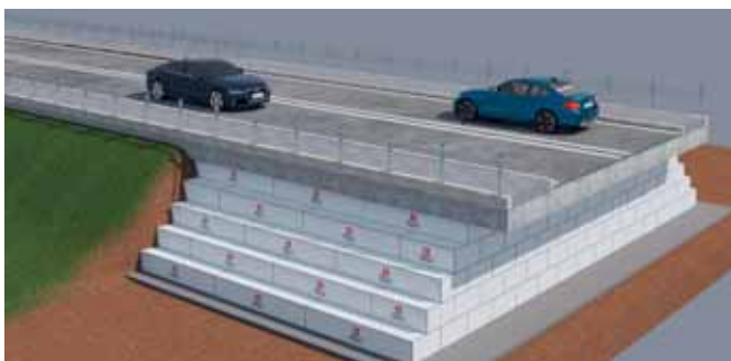
Снимка 1 Метод, използван за замяна на насип с почва на магистрали, мостове и рампи, тъй като облекчава проектното натоварване.
